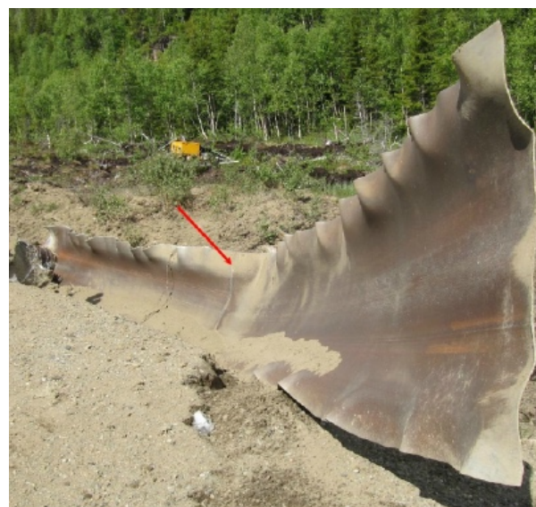
Figur 19: Løpende brudd i rørledning (fullskala forsøk).
